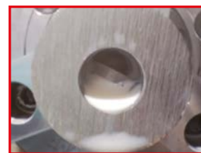
Nóż stalowy bez otworu na chłodziwo + oprawka SLV
